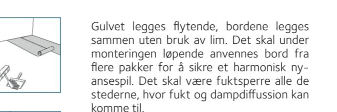
Parkettet legges flytende, bordene legges sammen uten bruk av lim. Det skal under monteringen løpende anvenes bord fra flere pakker for at sikre et harmonisk farge- og nyansspel. Det skal være fuktsperrere alle de stederne, hvor fukt og dampdiffusjon kan komme til.
