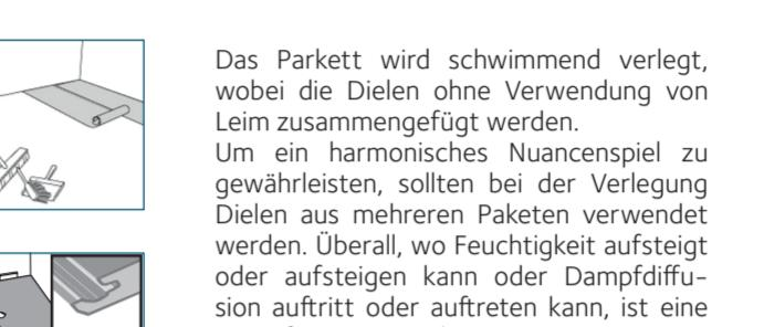
Parkett wird schwimmend verlegt, wobei die Dielen ohne Verwendung von Leim zusammengefügt werden. Um ein harmonisches Nuancenspiel zu gewährleisten, sollten bei der Verlegung Dielen aus mehreren Paketen verwendet werden. Überall, wo Feuchtigkeit aufsteigt oder aufsteigen kann oder Dampfdiffusion auftritt oder auftreten kann, ist eine Dampfsperre auszulegen.
